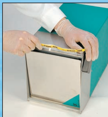
3. Cierra. Se activan las palas o usa el interruptor. La puerta fija la bolsa en su lugar.
