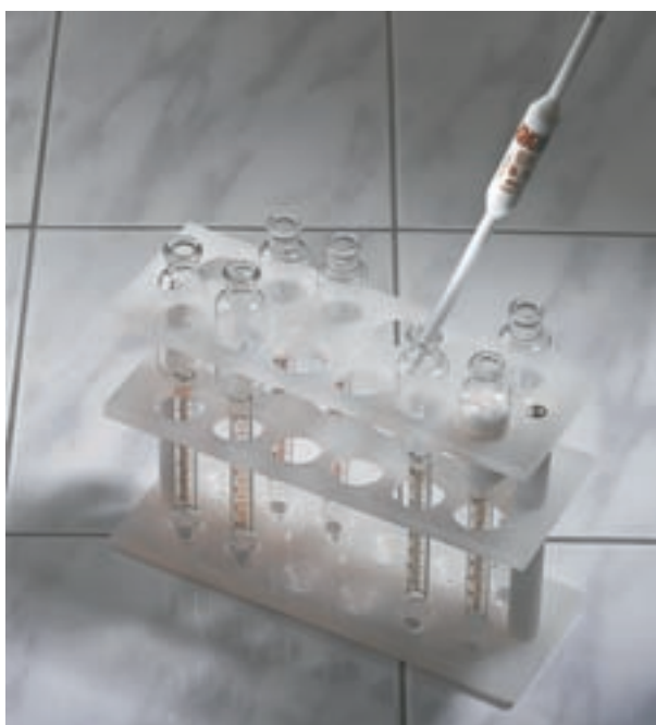
Imagen 2. Verter con la pipeta 10,75 ml de leche en el butirómetro.
