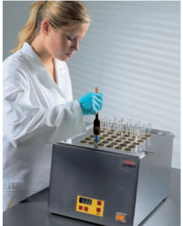
Imagen 5. Los butirómetros deben ser traídos a la temperatura de lectura exacta con el baño María.
