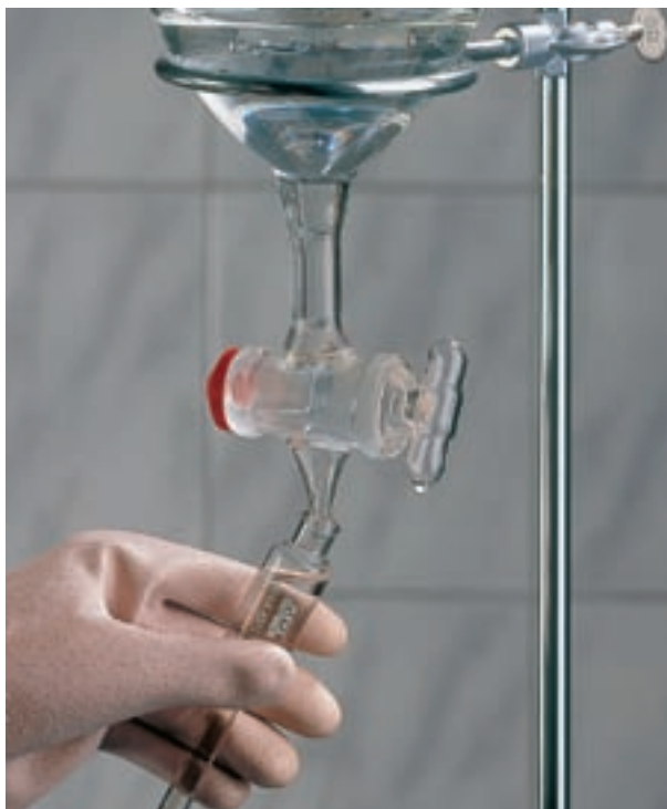
Imagen 1. Para envasar el ácido sulfúrico deben llevarse guantes de caucho y gafas de protección.
