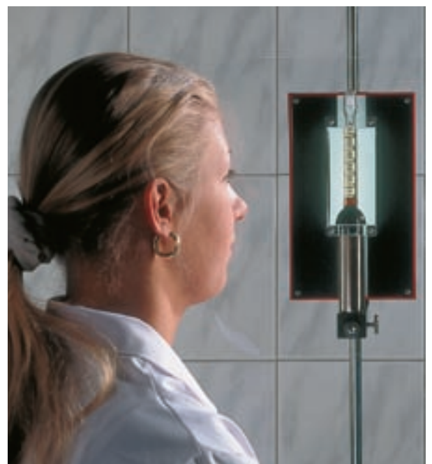
Imagen 6. Con ayuda de la lámpara de lectura de seguridad pueden verse los valores medidos de forma segura y exacta.
